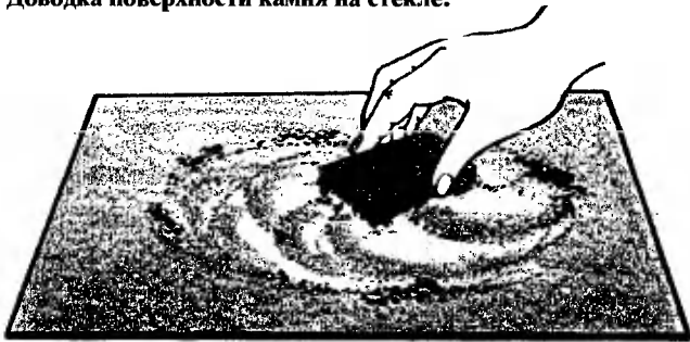
Доводка поверхности камня на стекле.
